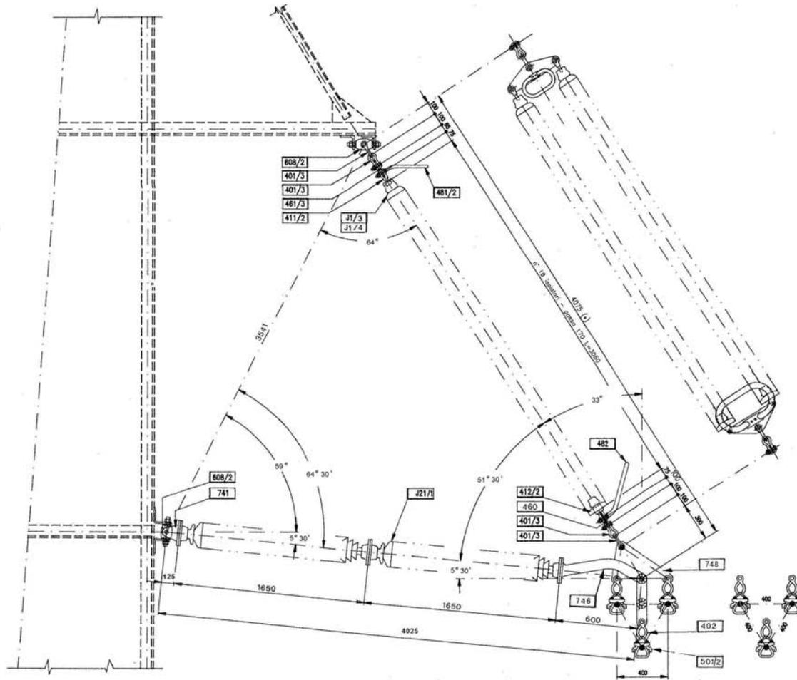
VISTA LATERALE ATTACCO CONDUTTORE INFERIORE
