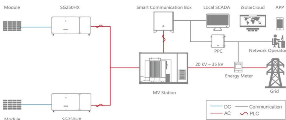
Figura 1 – Schema a blocchi impianto agro-voltaico con inverter di stringa
