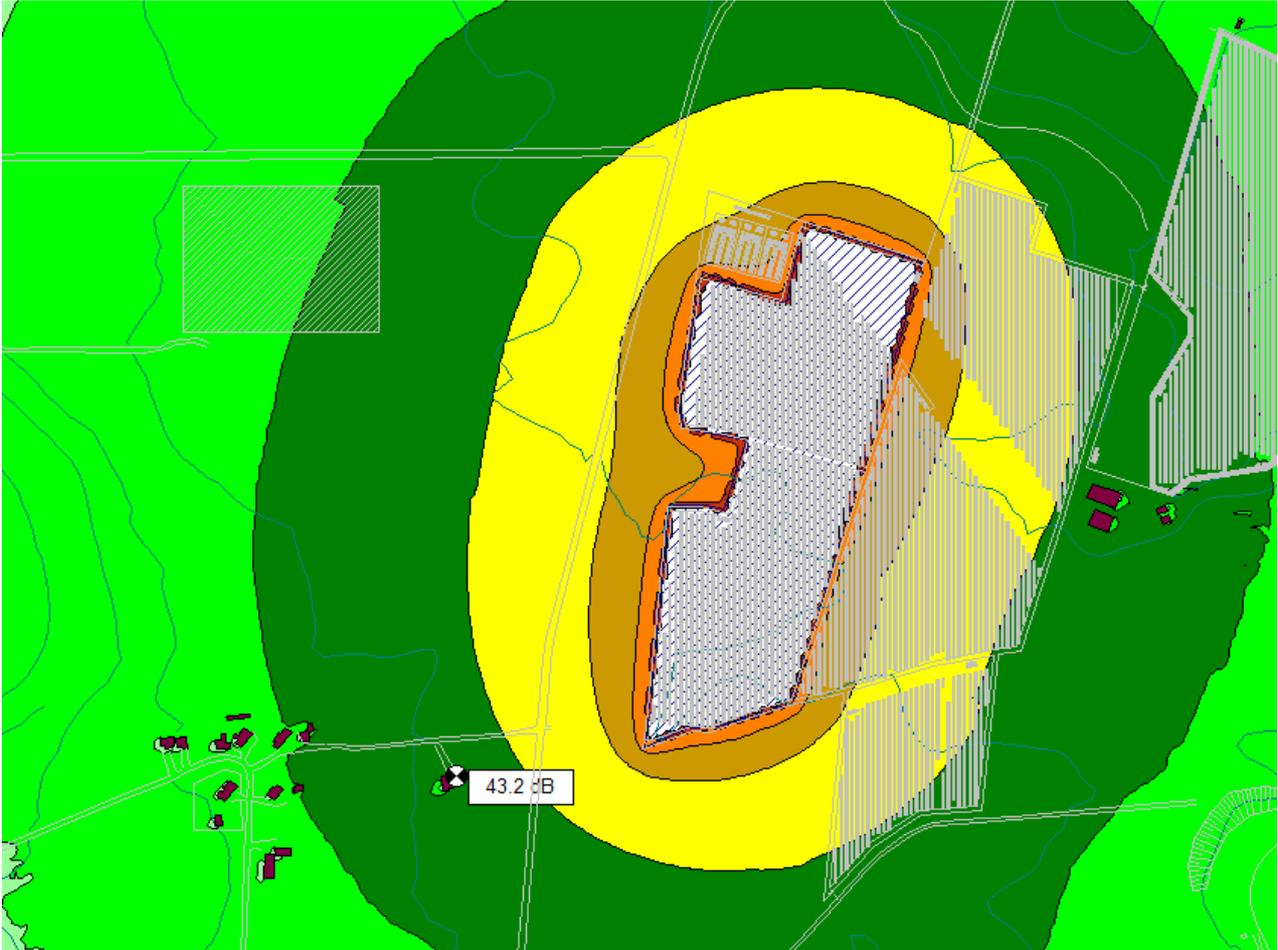
Figura 13 – Isofoniche del rumore generato nella lavorazione di infissione tracker zona ovest in prossimità del ricettore FV0075
