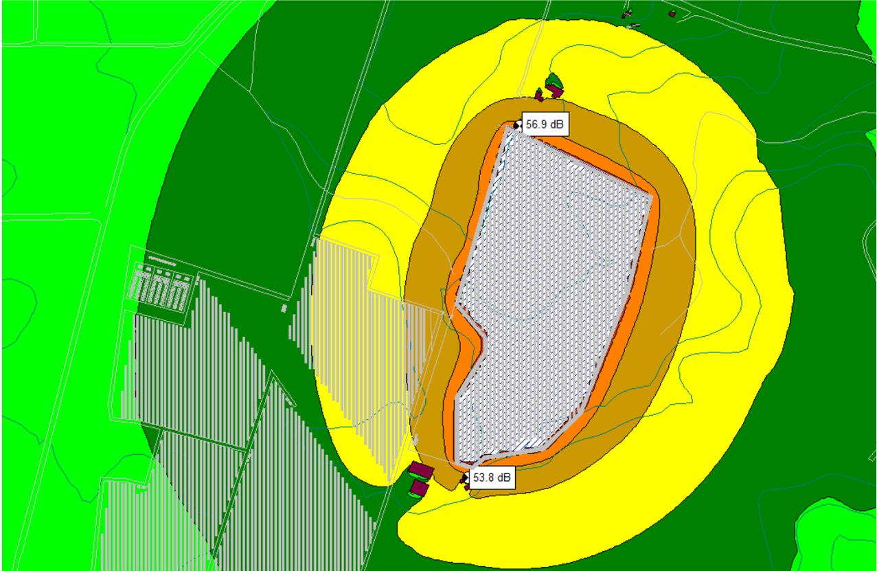
Figura 12 – Isofoniche del rumore generato nella lavorazione di infissione tracker zona nord est in prossimità dei ricettori FV0029 e FV0086
