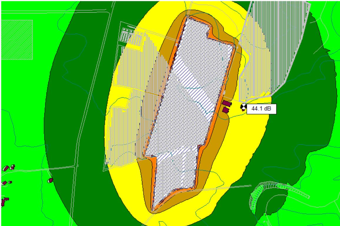
Figura 12 – Isofoniche del rumore generato nella lavorazione di infissione tracker zona centrale in prossimità del ricettore FV0086
