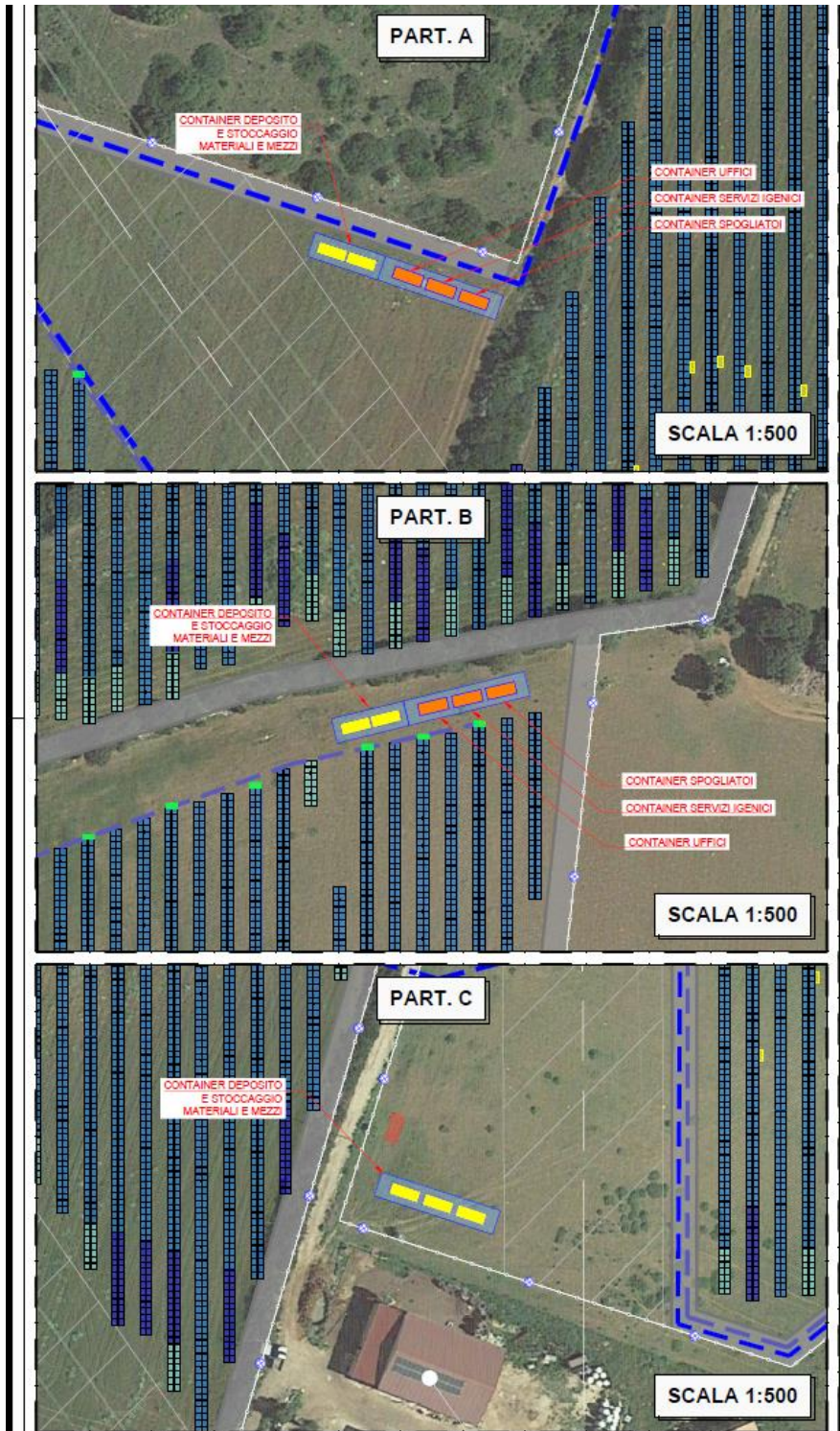
Figura 14 - Estratti della Tav. ELG_313 di progetto raffigurante la logistica di cantiere
