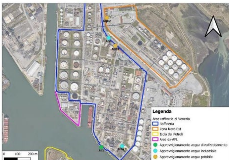
Figura 63: Punti di approvvigionamento idrico presso la Raffineria di Venezia
