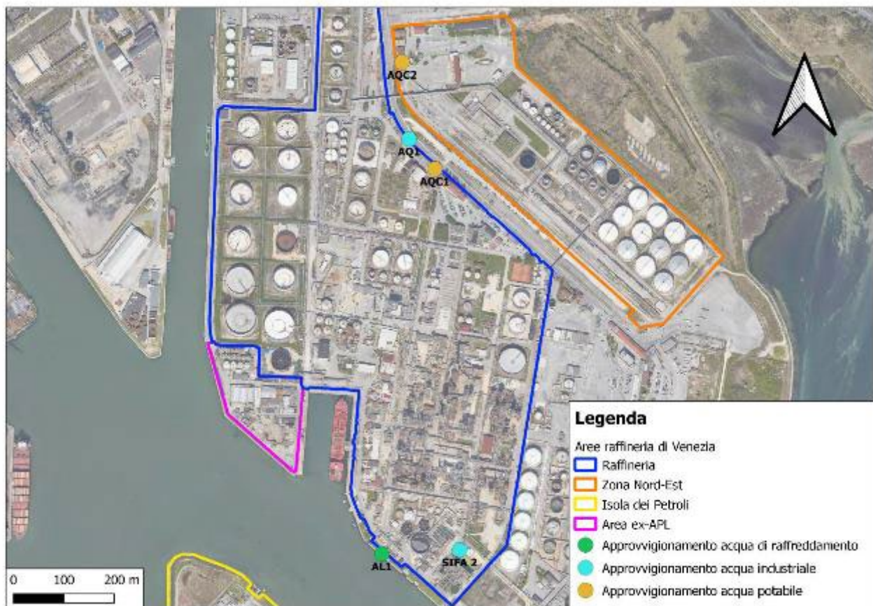
Figura 15: Punti di approvvigionamento idrico presso la Raffineria di Venezia
