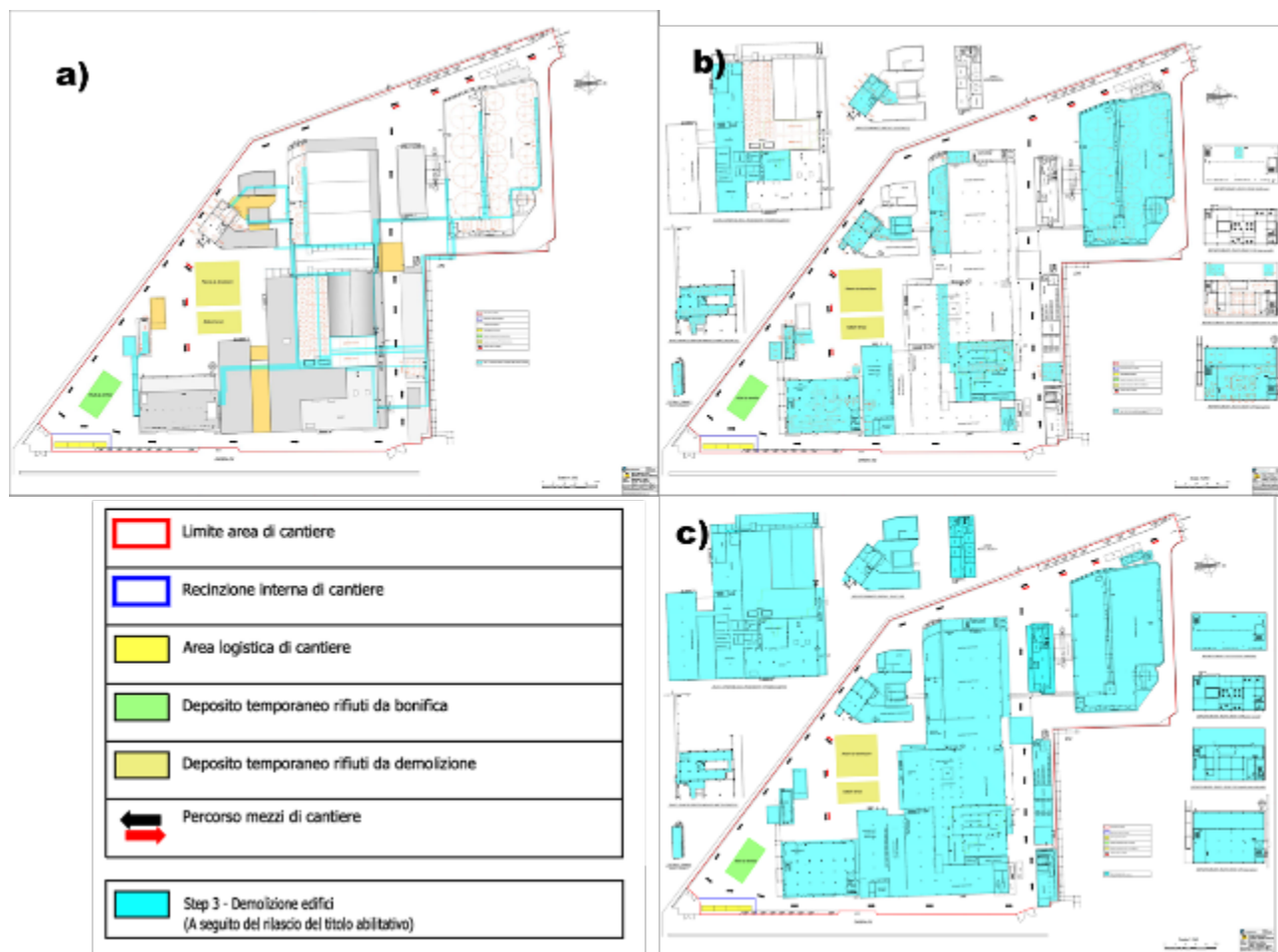
Figura 23: a) Attività di demolizione – Step 1 (Rimozione mediante smontaggio delle tubazioni bonificate); b) Attività di demolizione – Step 2 (Rimozione mediante smontaggio degli item bonificati, per i quali non è richiesto titolo abilitativo); c) Attività di demolizione – Step 3 (Demolizione edifici, a seguito del rilascio di titolo abilitativo)
