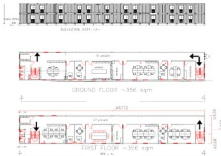
Figura 25: Ufficio di cantiere - schema tipologico
