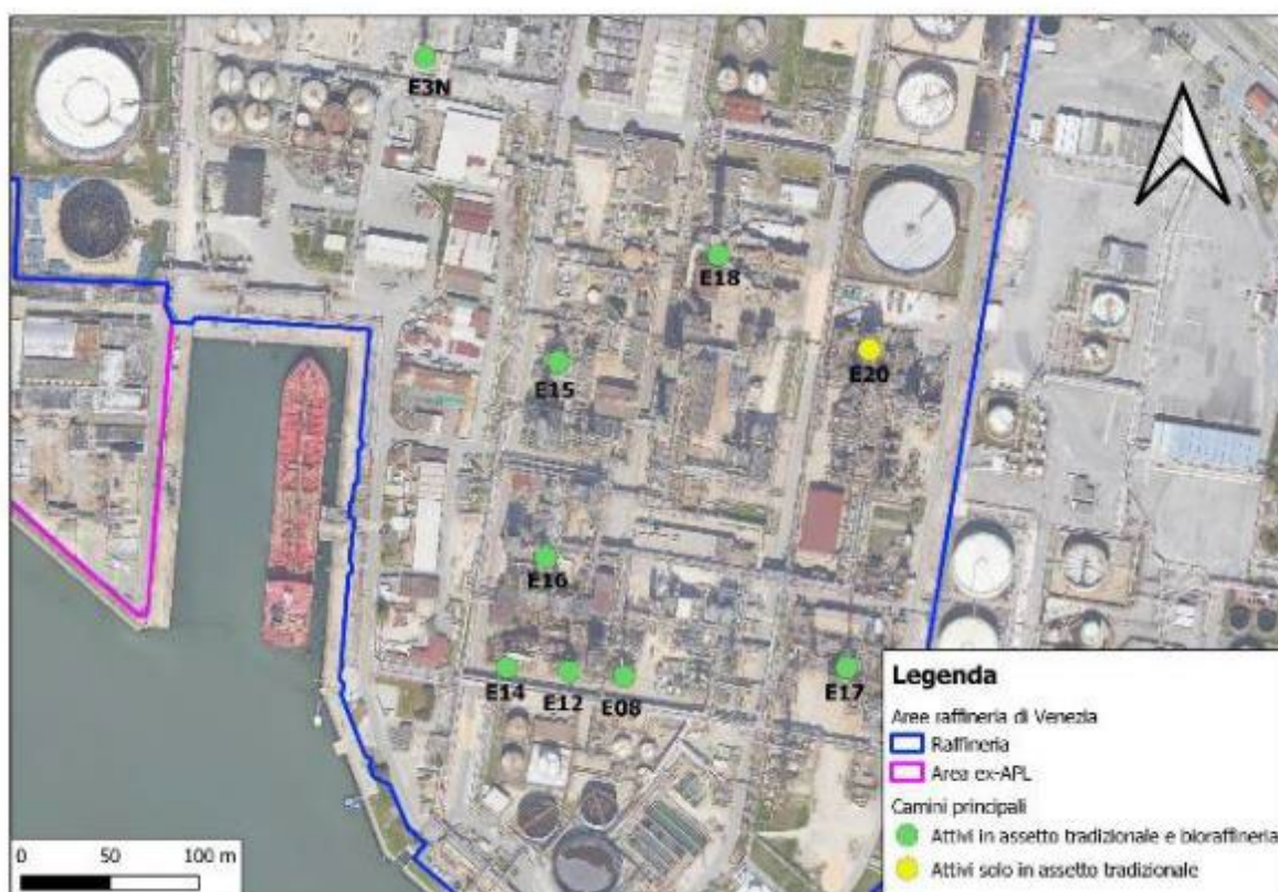
Figura 38: Principali punti di emissione di tipo convogliato presenti presso la Raffineria di Venezia Nell'area funzionale di "Raffineria" è inoltre presente anche un camino per l'emissione dell'aria a valle del trattamento ad opera dell'odour scrubber delle potenziali emissioni odorigene derivanti dagli impianti (Figura 64).
