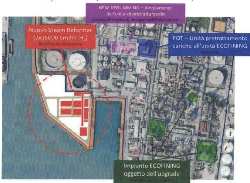
Figura 3. NUOVA CONFIGURAZIONE DI PROGETTO , cerchiate le NUOVE MODIFICHE oggetto di VIA (cfr. Studio di Impatto Ambientale SIA_BioRaVe_SR_1-2: Introduzione; definizione dell’opera e analisi delle motivazioni).
