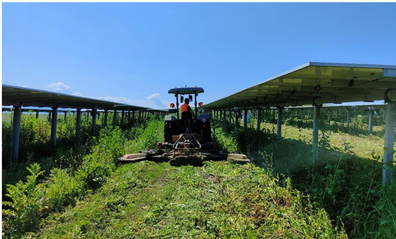
Foto 6 – Un trattore fra le stringhe in posizione orizzontale sfalcia la vegetazione spontanea.
