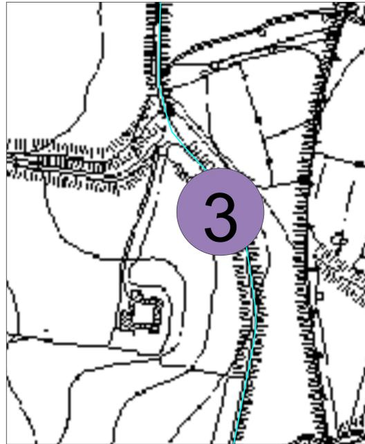
Il tracciato del cavidotto MT di connessione alla rete interferisce con un chiusino stradale. Non risulta essere nota la profondità di posa dei sottoservizi contenuti.
