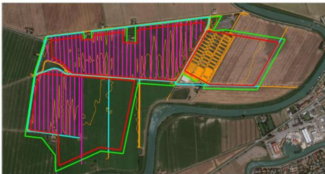
Fig. 2 Inquadramento dell'area di progetto (in rosso), su rilievo topografico con passo 50 cm (in arancione), canali di scolo esistenti (in Ciano), fossi per irrigazione (in magenta) e area contrattualizzata (in verde).
