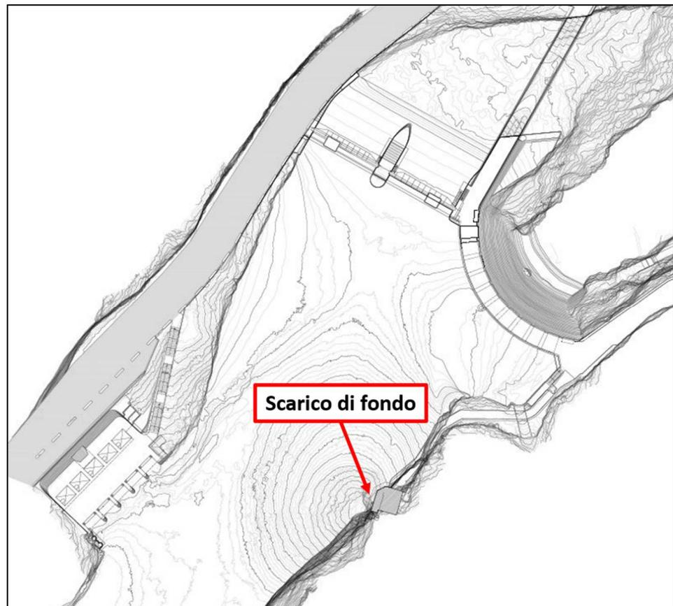
L'imbocco dello scarico di fondo è situato in sponda destra con soglia a quota 152.58 m s.l.m.
