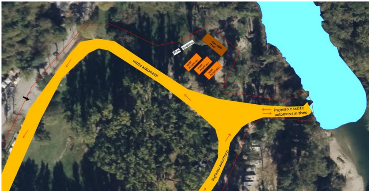
Figura 6.3 Rappresentazione schematica del possibile layout di cantiere ipotizzando l'ingombro minimo degli spazi nell'area "La Golena".
