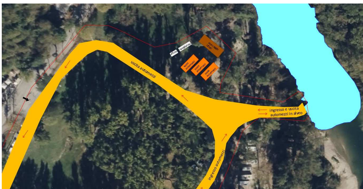
Figura 4-2: rappresentazione schematica del possibile layout di cantiere ipotizzando l'ingombro minimo degli spazi dell'area "La Golena".
