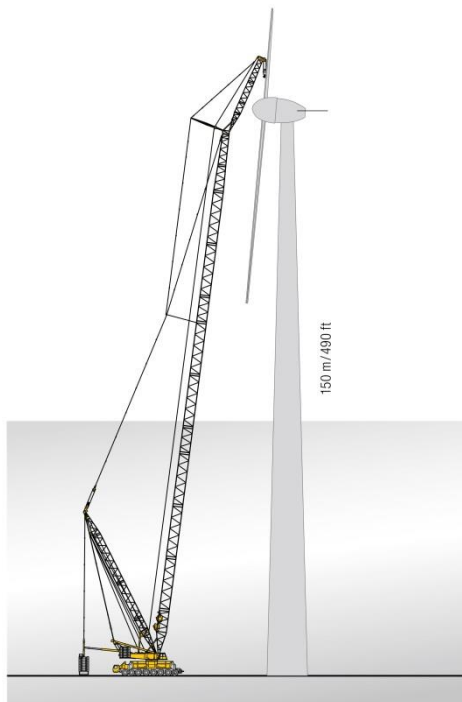
Figura 5.66 – Schema di una gru cingolata a traliccio con sistema derrick impiegata per l'innalzamento delle turbine eoliche dell'ultima generazione
