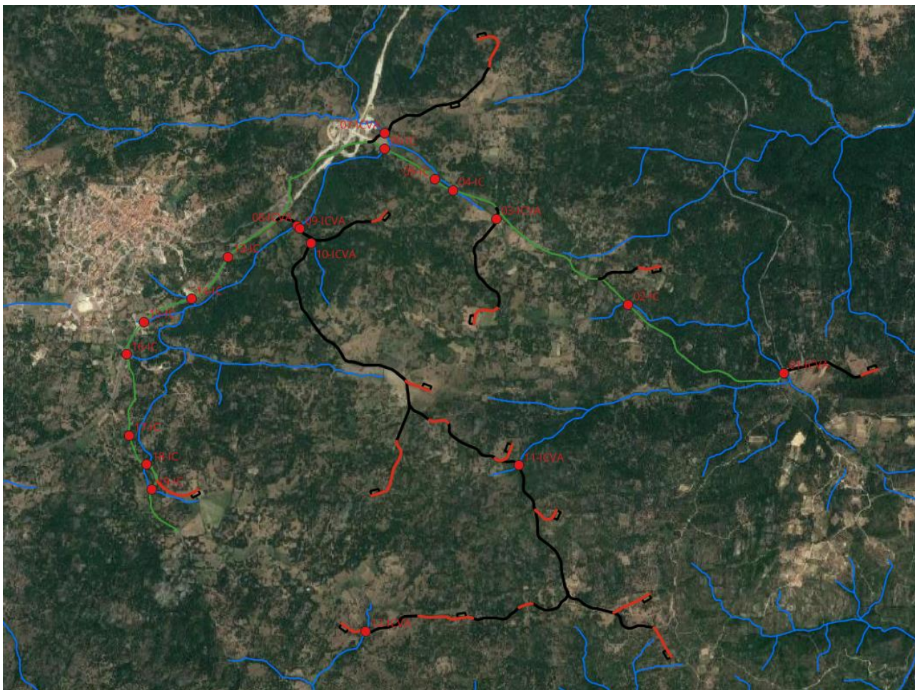
Figura 1.1 - Planimetria di progetto su ortofoto con individuazione del reticolo idrografico della Regione (in rosso la viabilità di progetto da realizzare, in nero la viabilità da adeguare, in verde il cavidotto)
