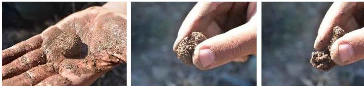
*Figura 10.83- Test della tessitura: A seguito della bagnatura di un campione di terra è possibile effettuare una stima della tessitura in campo secondo una sequenza prestabilita di manipolazioni. Da questo campione facendo una pressione ad una piccola sfera questa si rompe senza appiattirsi il che significa che la tessitura può essere sabbioso franco.*
