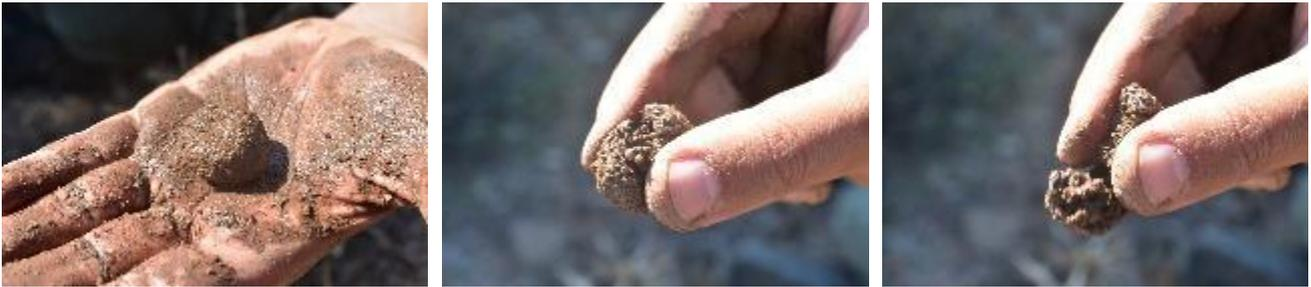
Figura 3.51– Test della tessitura: A seguito della bagnatura di un campione di terra è possibile effettuare una stima della tessitura in campo secondo una sequenza prestabilita di manipolazioni. Da questo campione facendo una pressione ad una piccola sfera questa si rompe senza appiattirsi il che significa che la tessitura può essere sabbioso franco.
