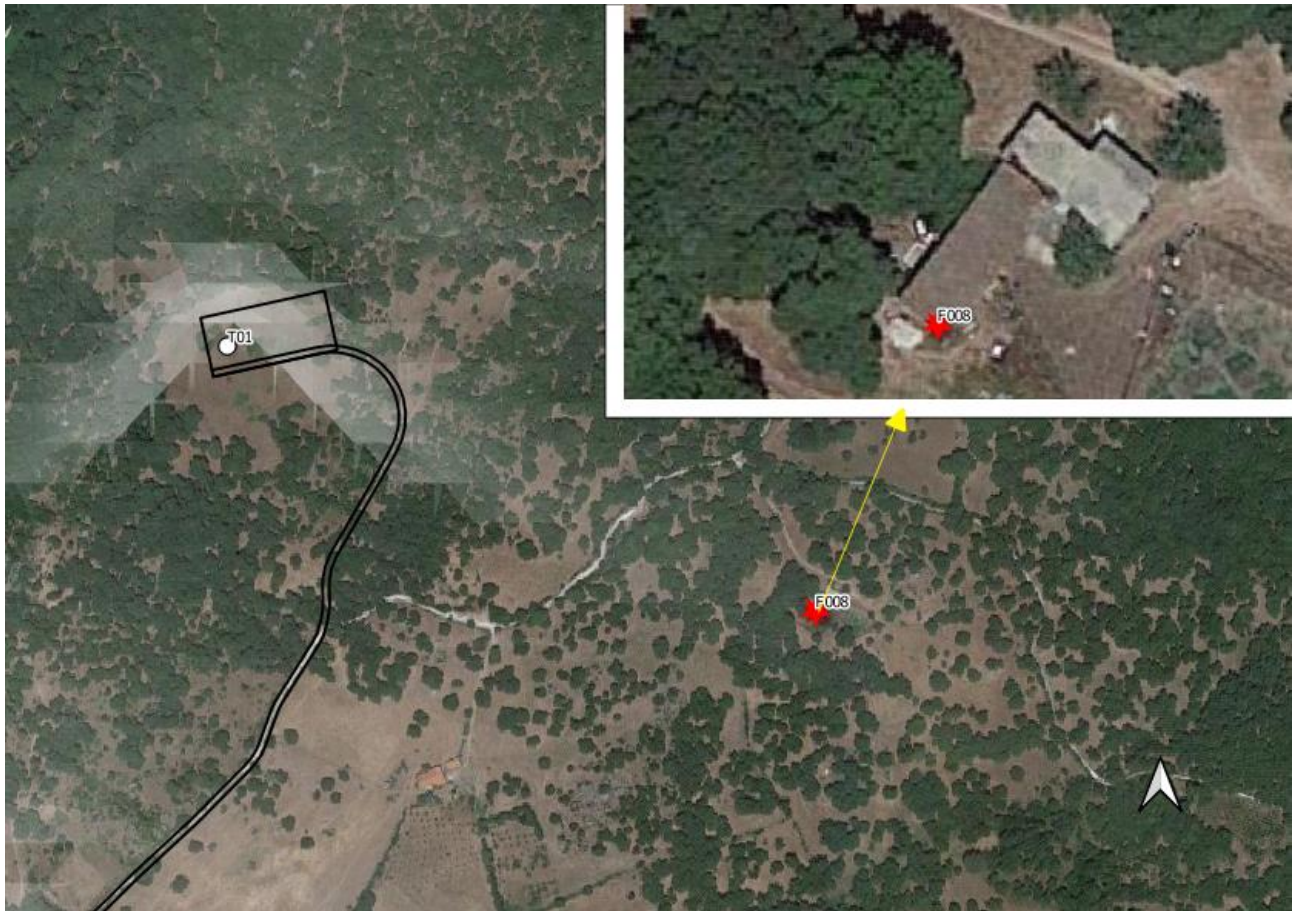
Figura 6.2 – Posizionamento del ricettore F008 rispetto all'aerogeneratore T01. In evidenza, con sfumatura bianca, le isolinee d'ombra. Si nota come l'esistente barriera arborea esercita un efficace effetto schermante sul potenziale ombreggiamento intermittente riferibile, in particolare, all'aerogeneratore T01, posizionato a nordovest
