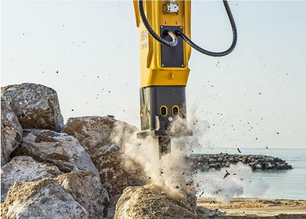
**Figura 16.** Utensile martello demolitore (Fonte: elaborazione propria).
