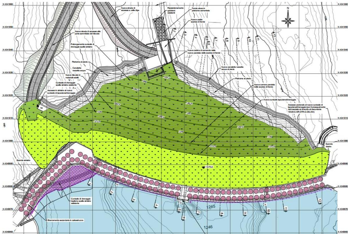
Figura 30: geometria del rilevato di valle, planimetria
