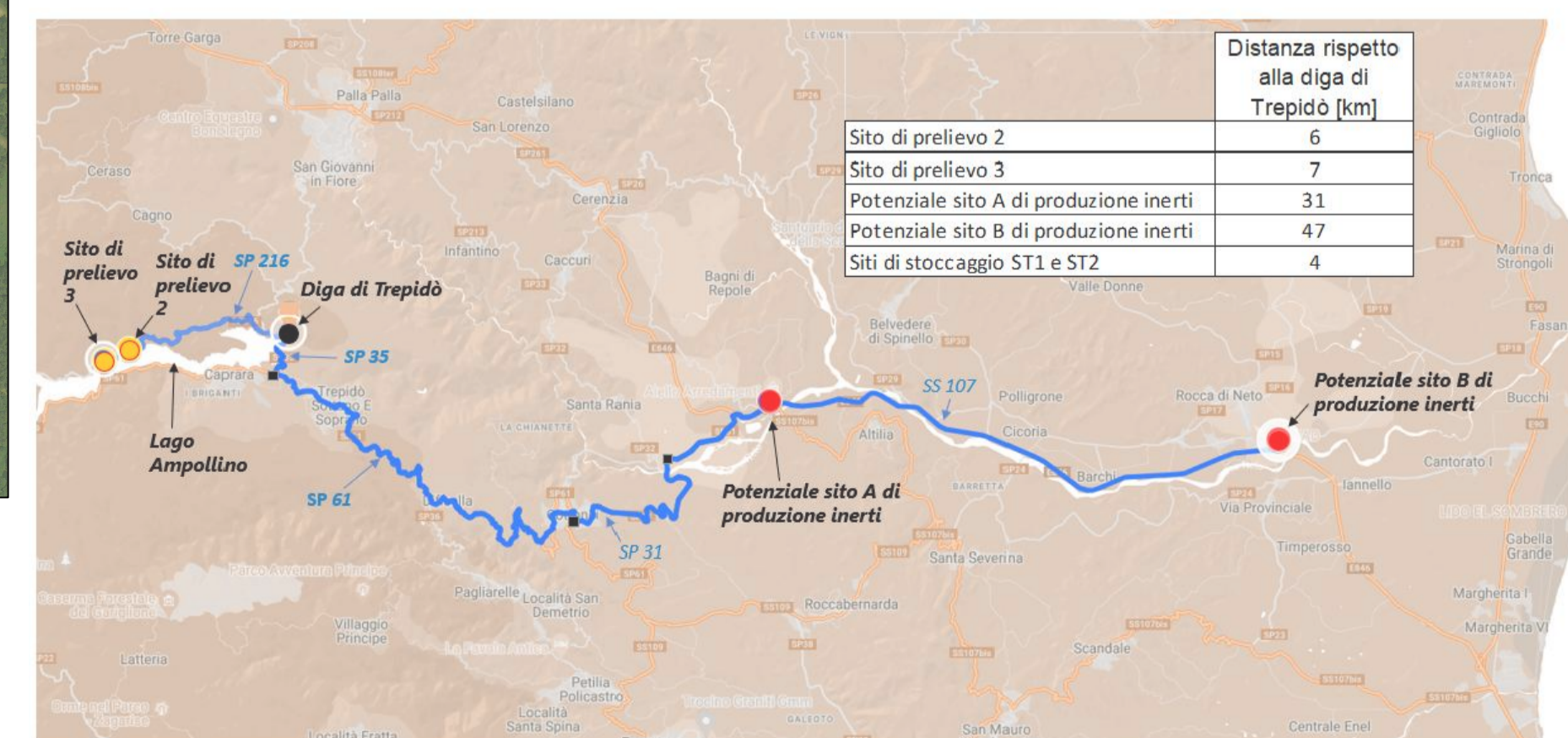
TRACCIATI STRADALI E DISTANZE DALLA DIGA DEI POSSIBILI SITI DI APPROVVIGIONAMENTO DEI MATERIALI PER LA REALIZZAZIONE DEL RILEVATO
