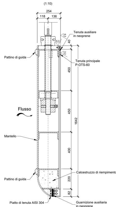
**Dettaglio 1 Tenuta superiore e asta servomotore**
