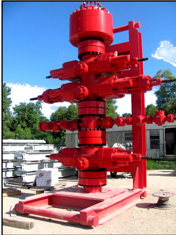
Figura 3.4.5.2a Esempi di BOP “Annular” (da RIG MANUFACTURING LLC)
