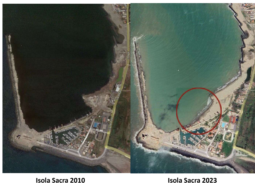
Figura 1. Alterazione della linea di riva dovuta alla presenza del molo Traiano
