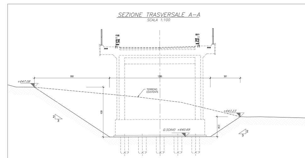
NOTA: SCAVO IN FALDA DA PREVEDERE CON POMPE DI AGGOTTAMENTO
