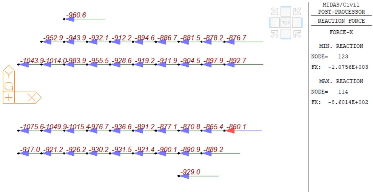
Figura 127 – Reazioni in direzione longitudinale
