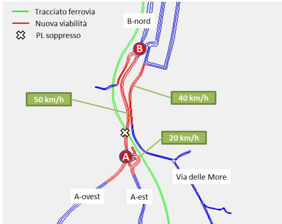
Figura 4 - Schema di rete dello scenario di progetto con indicazione delle velocità
