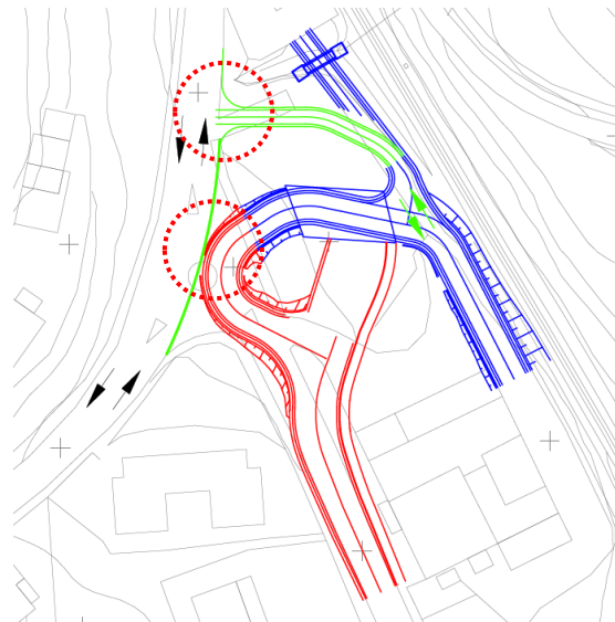
SS93 - Completamento ramo di ricucitura via Padre Pio e Realizzazione innesto ramo provvisorio per accesso Azienda Vinicola
