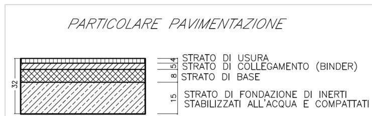
Dettaglio pavimentazione stradale
