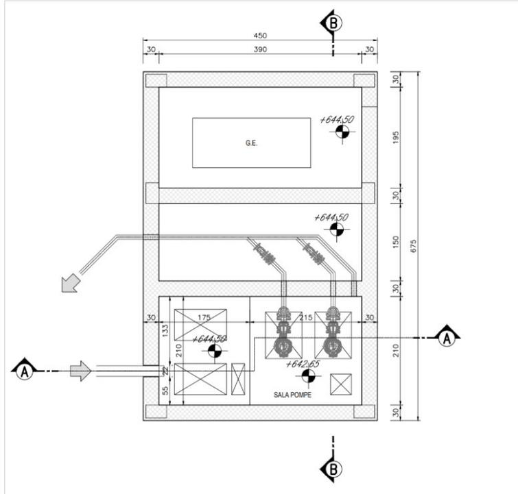
Pianta del nuovo fabbricato di alloggiamento dell'impianto
