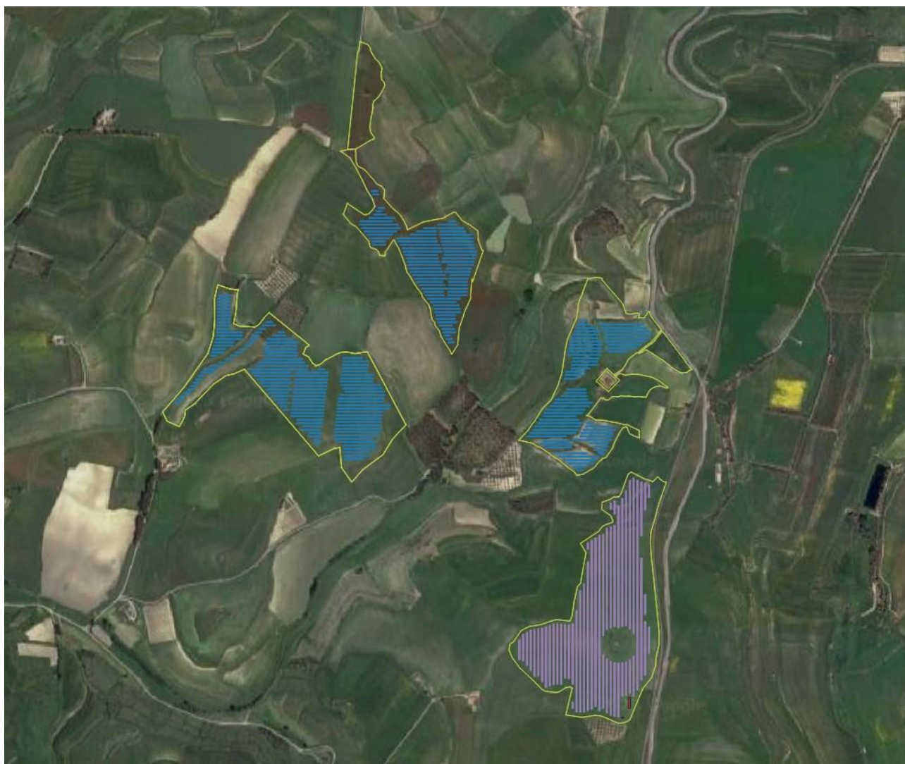
Figura 8 Layout dell'impianto Agrivoltaico Pannelli fissi _____ Pannelli a inseguimento _____
