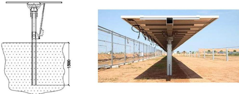
Figura 3: Sezione della profondità di infissione dei pali di sostegno e particolare dei moduli pronti al cablaggio
