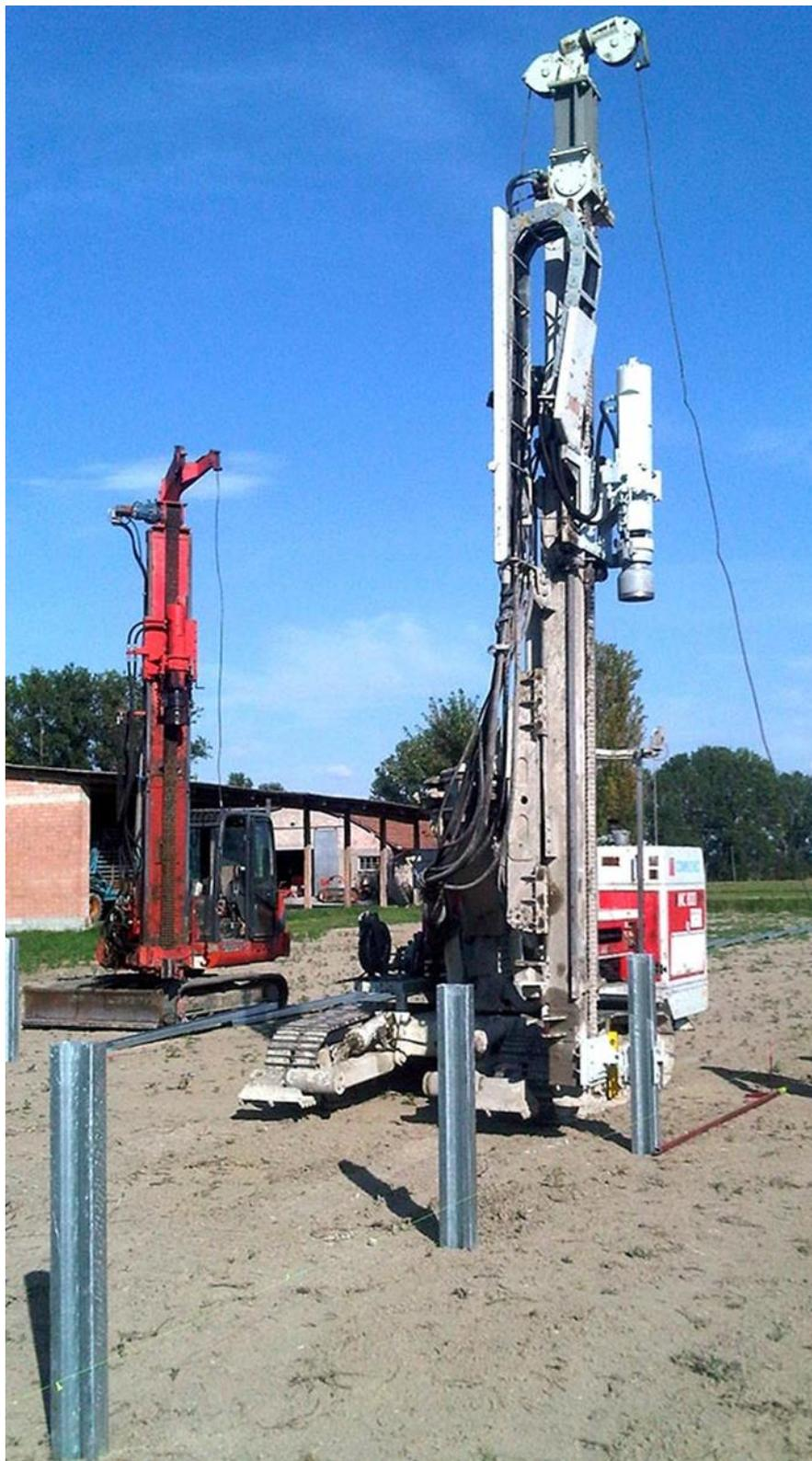
Figura 2: Esempio di Macchina Operatrice Battipalo
