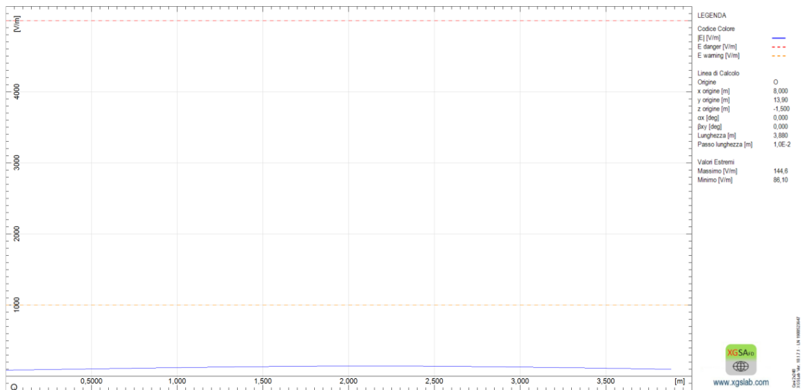
Figura 3: Profilo Campo Elettrico ad altezza 1,5 m
