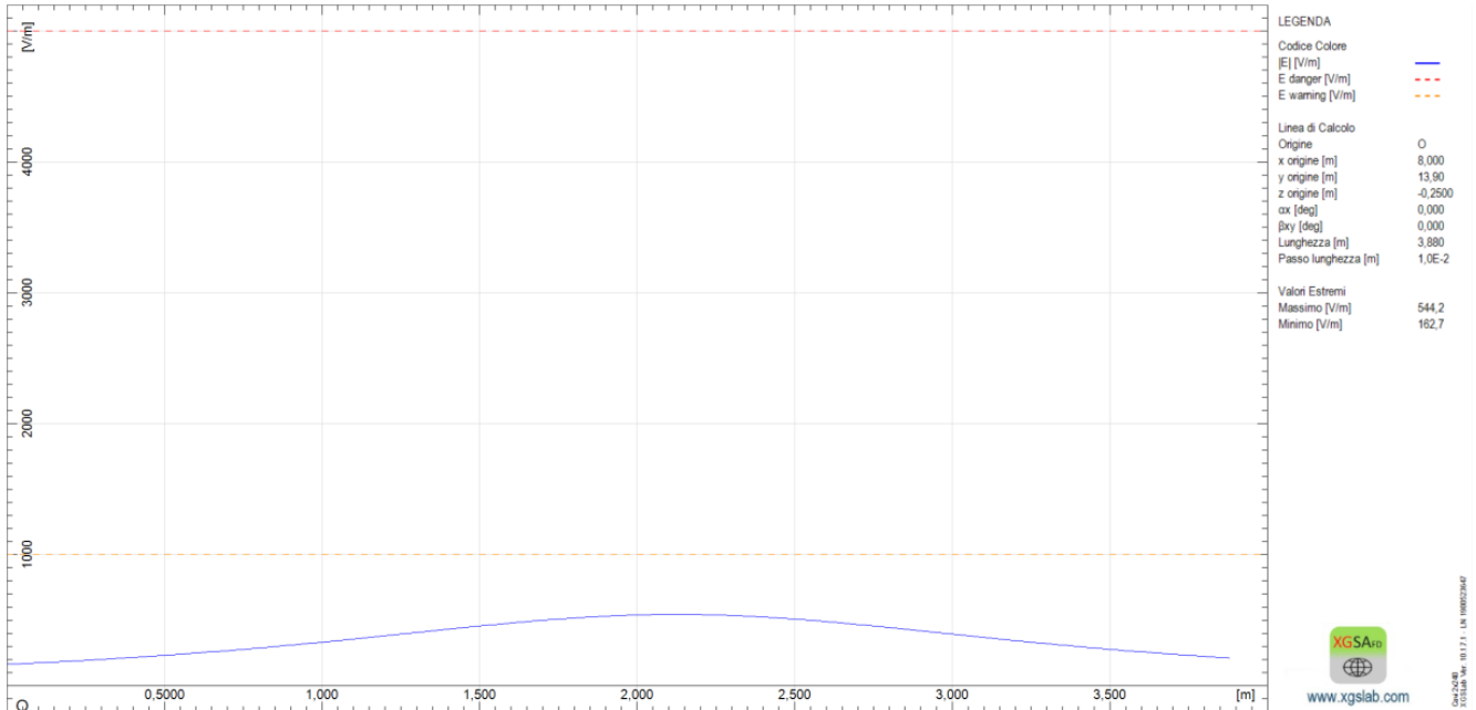
Figura 6: Profilo Campo Elettrico ad altezza 0,25 m
