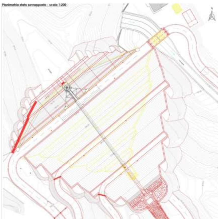
Figura 1 estratto della planimetria dello stato sovrapposto dell'opera di sbarramento. In giallo lo stato attuale, in rosso gli interventi in progetto (elaborato T-P02_s)
