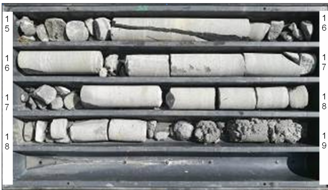
Figura 17 - Formazione arenacea e calcarenitica
