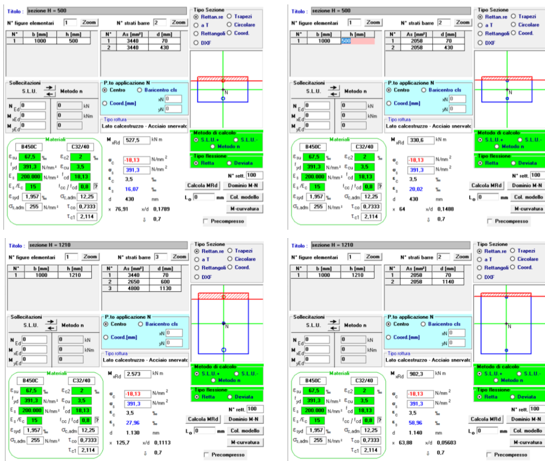
Figura 8-1 Determinazione dei momenti resistenti in direzione y e z, sezioni A e B
