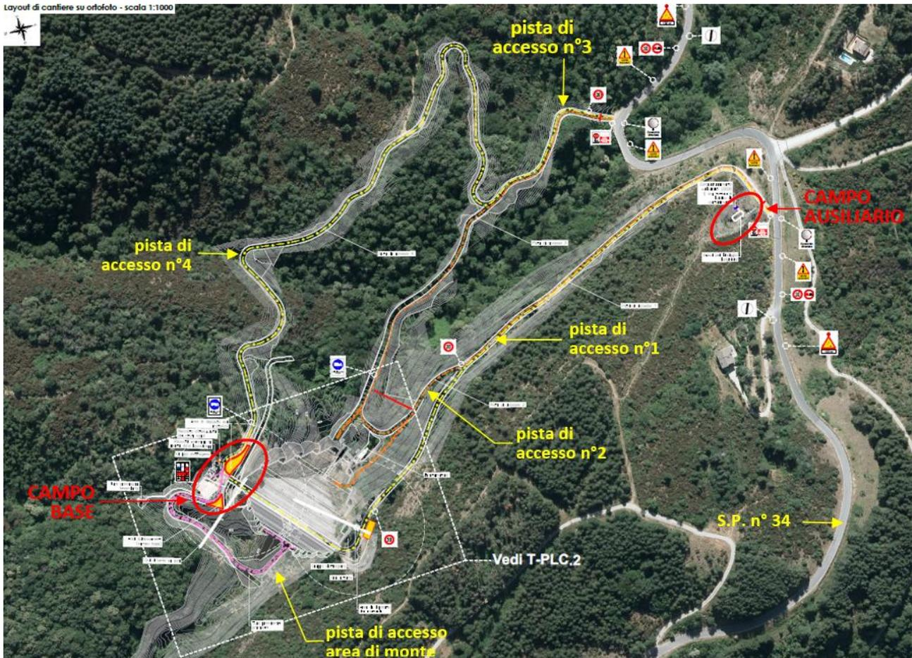
Figura 6: rappresentazione su foto aerea delle piste di cantiere
