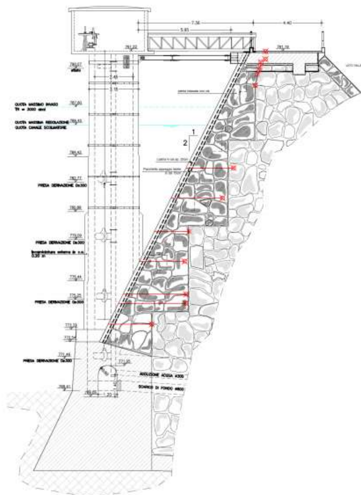
Figura 4 Assetto del paramento di monte ricostruito sulla base dei carotaggi e saggi distruttivi effettuati nel 2015.
