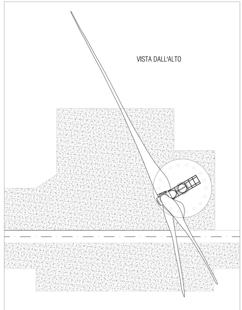
Nota: Le dimensioni riportate sono relative ad un modello generico di turbina di grande taglia. In base al modello di aerogeneratore selezionato in fase esecutiva, tali dimensioni potranno variare rispettando comunque l'altezza complessiva massima di 200 m (diametro del rotore, massimo 170 m; altezza al mozzo, massimo 115 m).
