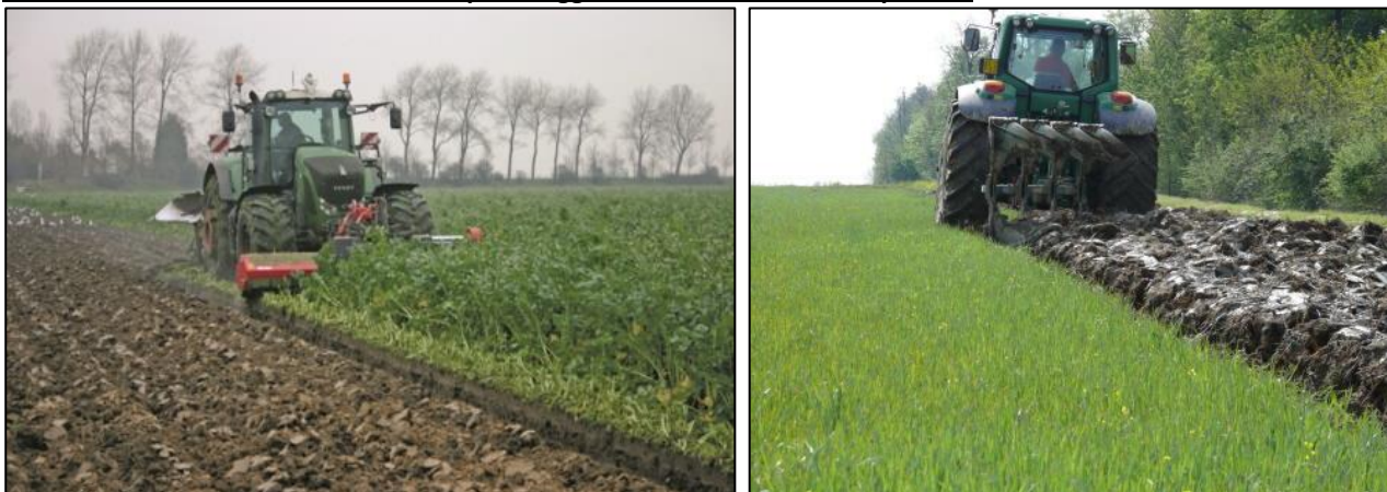
Fig. 6.3: Esempio di pratica del sovescio in pieno campo. Si noti, nell'immagine a sinistra, l'impiego di una trincia frontale montata sulla stessa trattore per alleggerire il carico sull'aratro portato
