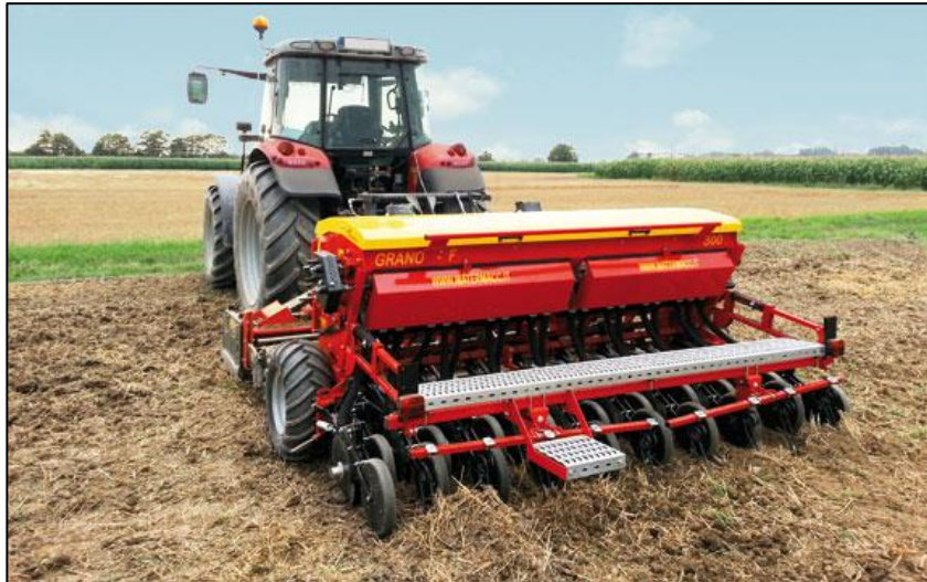
Fig. 6.4: Esempio di seminatrice di precisione per tutte le tipologie di sementi (Foto: MaterMacc S.p.a.)
