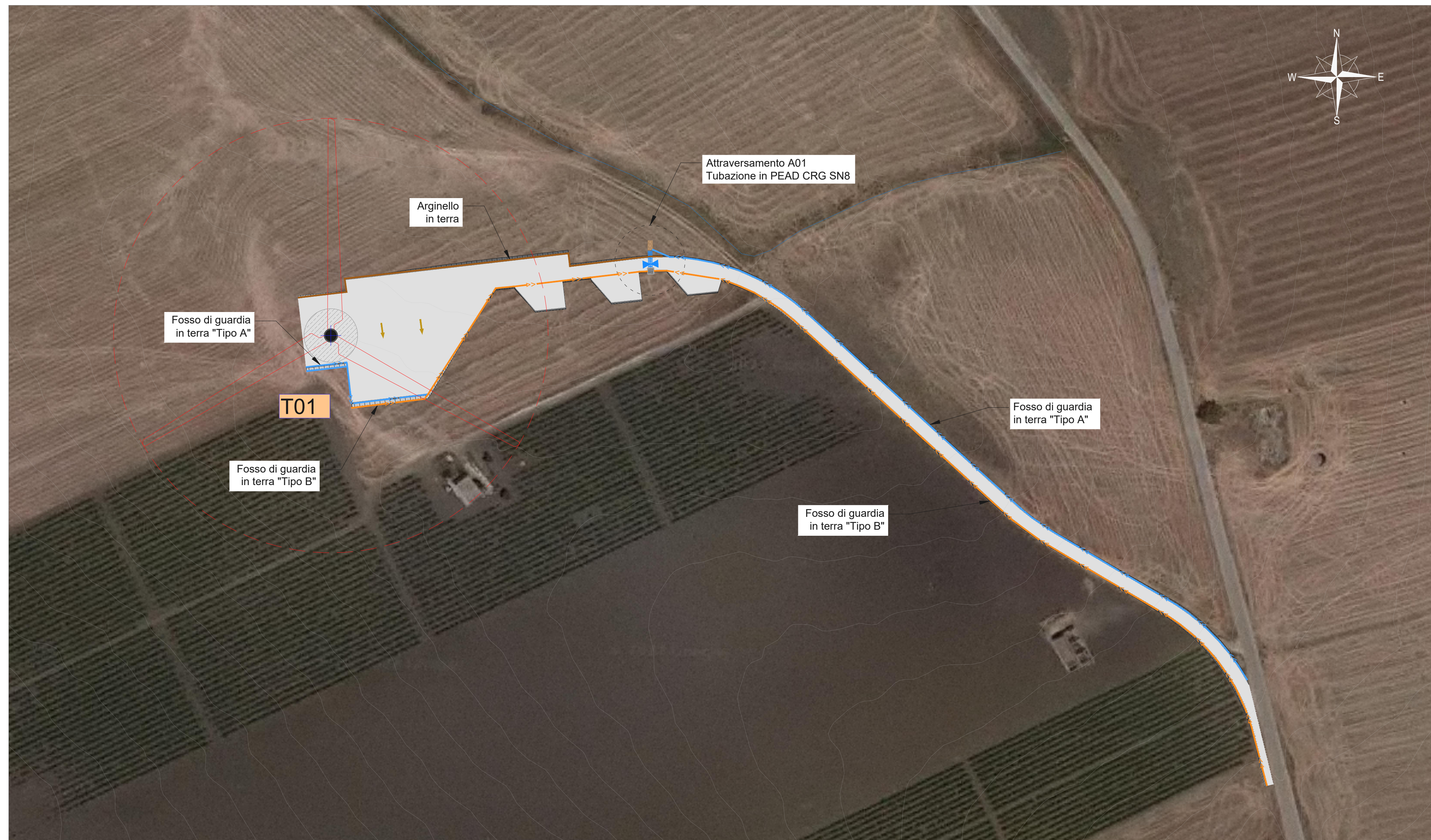
Layout opere idrauliche Asse T01 - Scala 1:1.000
