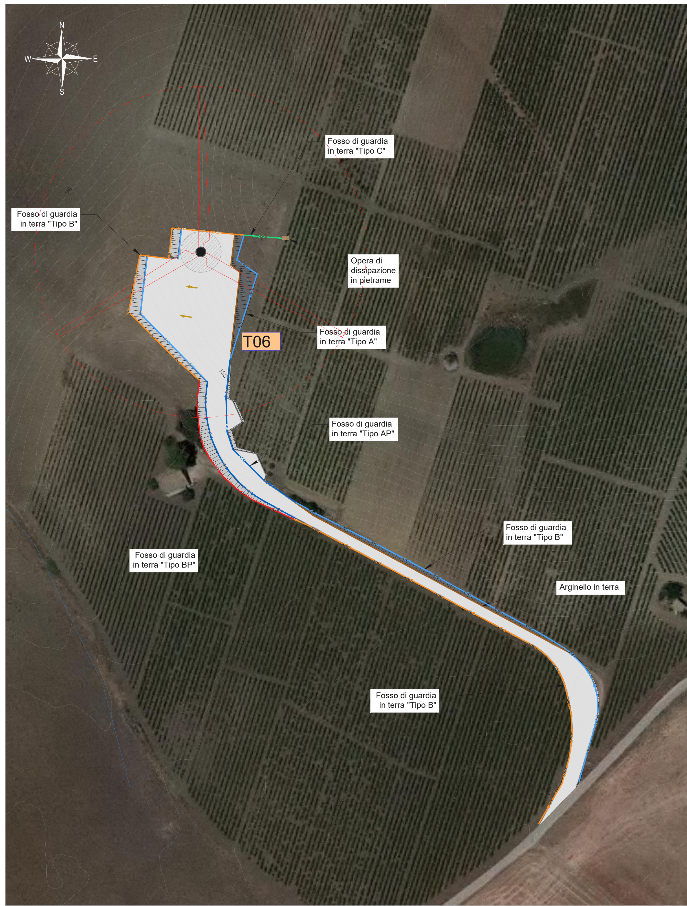
Layout opere idrauliche Asse T06 - Scala 1:1.000
