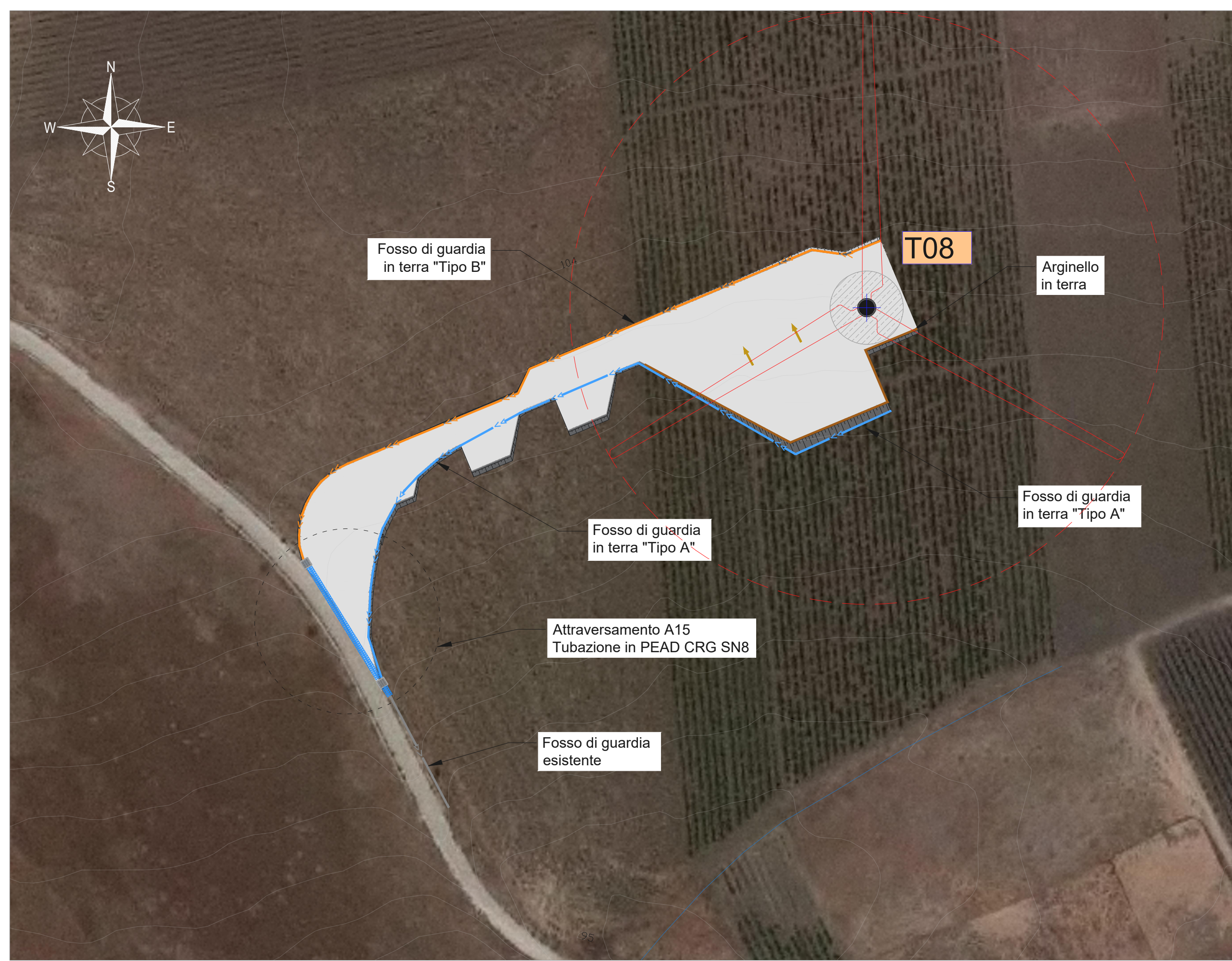
Layout opere idrauliche Asse T08 - Scala 1:1.000
