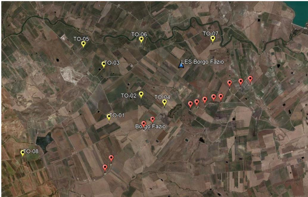
In rosso sono indicati gli aerogeneratori in esercizio di terzi entro la distanza di 1,5-2 km dalle posizioni del layout di Borgo Fazio in oggetto. Questi sono gli aerogeneratori considerati nei calcoli per i calcoli di scia e la stima della produzione. Oltre questa distanza, maggiore di 10 diametri di rotore, gli effetti di scia sono stati considerati trascurabili.
