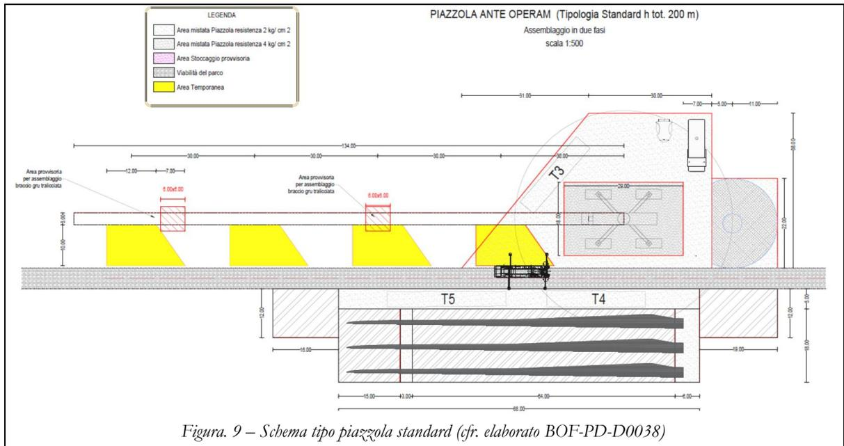
Figura 9 – Schema tipo piazzola standard (cfr. elaborato BOF-PD-D0038)
