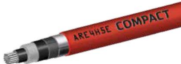
Figura 14 - Cavo unipolare ARE4H5E 18/30 kV
