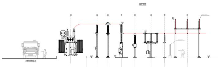
PROFILO ELETTROMECCANICO - SEZIONE BB' - Scala 1:200
