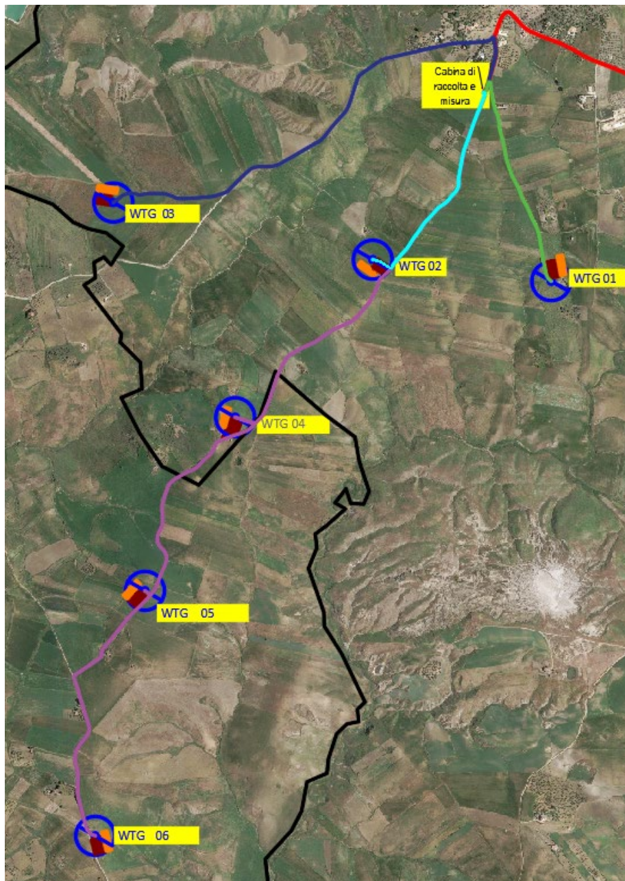
Figura 8 Tratte elettriche dell'Impianto Eolico su Ortofoto
