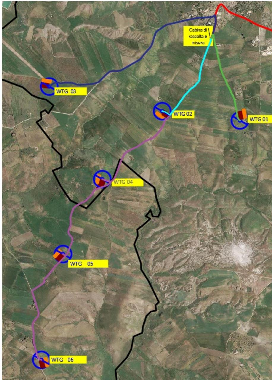
*Figura 1 Ortofoto impianto EO con cavi in progetto – collegamenti aerogeneratori / cabina di raccolta utente*
