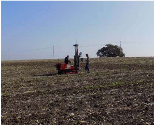
FOTO 1 - ESECUZIONE PROVA DPSH 1
