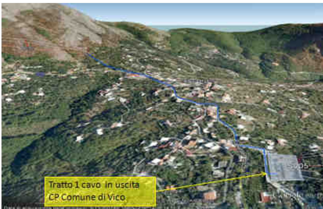
Figura 8: nuovo tratto in cavo in uscita dalla CP di Vico.
