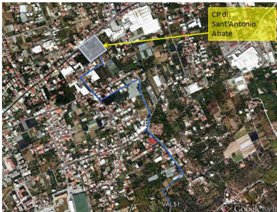
Figura 11: nuovo tratto in cavo zona comunale di S. Antonio Abate dal VAL51 fino ingresso CP.
