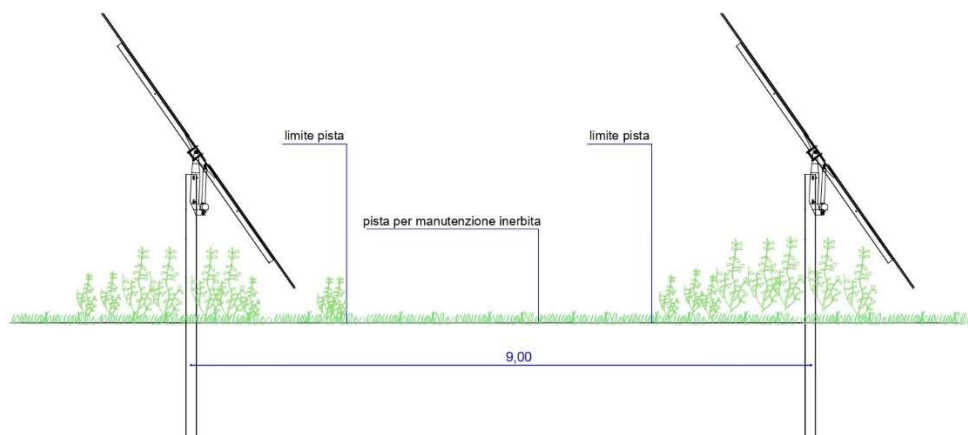
Fig.97 Piste inerbite tra le strutture a vela
