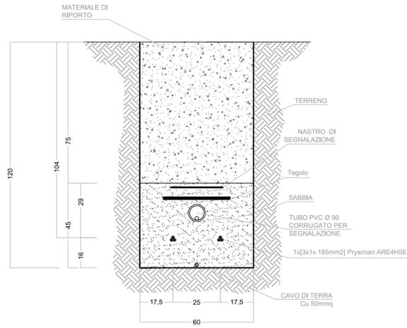
SEZIONE TIPO SINGOLA TERNA
