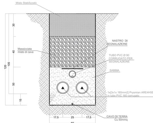
SEZIONE TIPO SINGOLA TERNA
